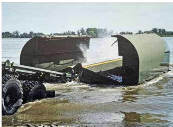
Samoczynne rozkładanie się pontonów parku IRB po zrzuconiu do wody
