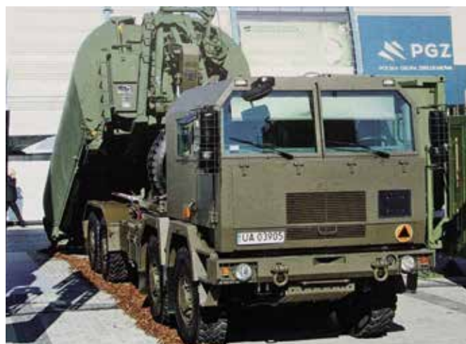
Jelcz 882.53 8x8 z hakowym systemem załadunkowym Cargotec Multilift MK IV z pontonem głównym parku IRB
