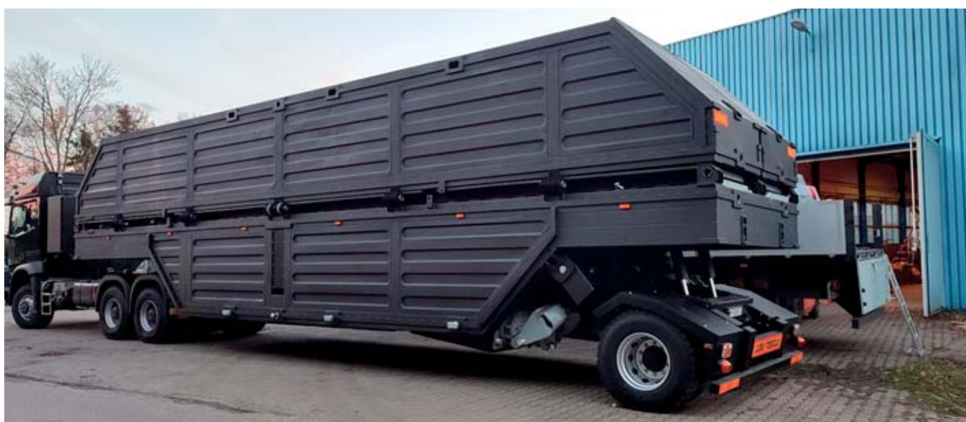
Ogólny widok promu PEP.30-01 w zestawie z terenowym ciągnikiem siodłowym (źródło: zbiory ARMPOL)
