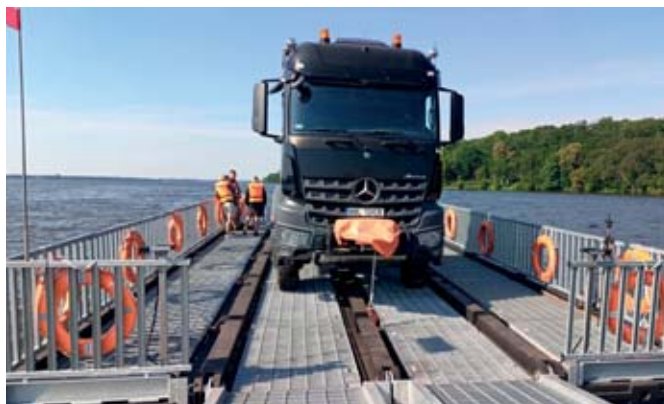
Wykorzystanie promu PEP.30-01 do przeprawy przez przeszkodę wodną ciężkiego sprzętu samochodowego (źródło: zbiory ARMPOL)
