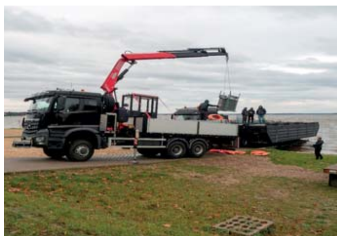
Montaż wyposażenia promu PEP.30-01 z wykorzystaniem HDS (źródło: zbiory ARMPOL)
